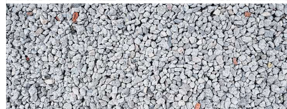
Das beim Rückbau gewonnene Material muss sortiert und gereinigt werden, so entsteht neues Rohmaterial für neue Bauwerke
