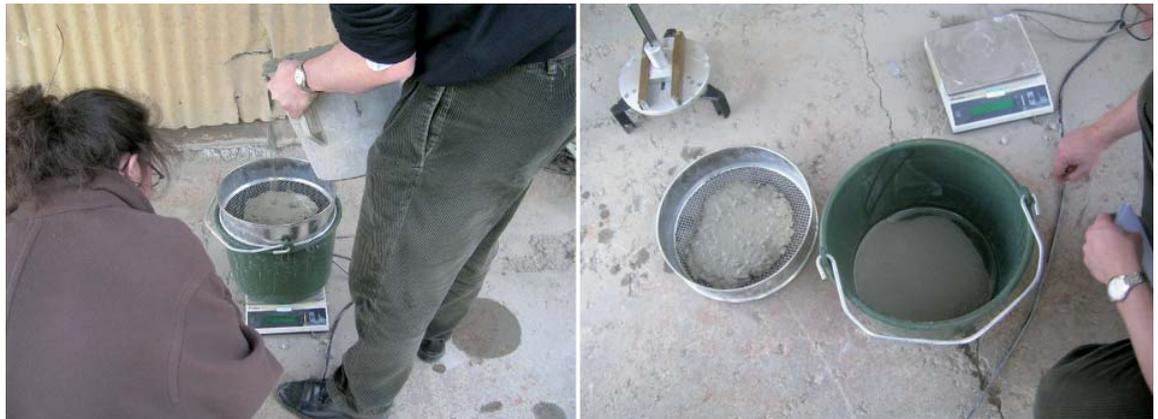
Abb. 8.4: Siebtest zur Prüfung der Sicherheit gegen Entmischung
